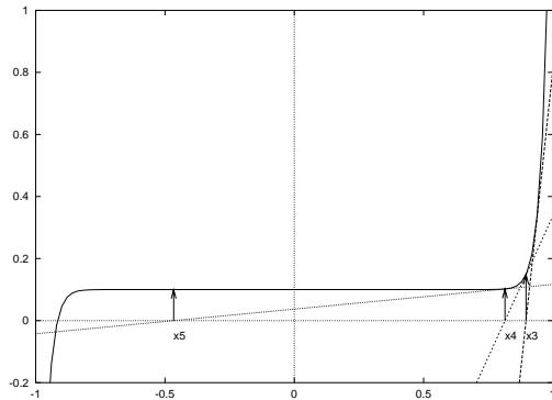
$x_k = -0.46639$  の辺りで接線の傾きが計算機の限界<sup>(3)</sup>を下回ってしまい、 $x$  軸に平行な接線と判断してしまいます。これでは、ニュートン法が続行できなくなります。
